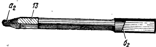
Рис. 12. Ударник: b_3 — ударник 2-5; a_2 — боек; b_2 — уступы
